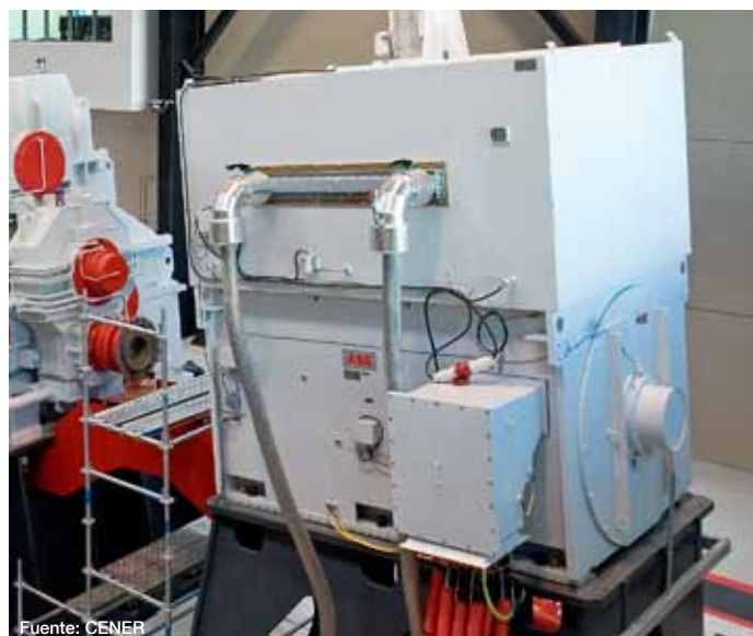
Motor ABB en uno de los bancos de ensayos del CENER
