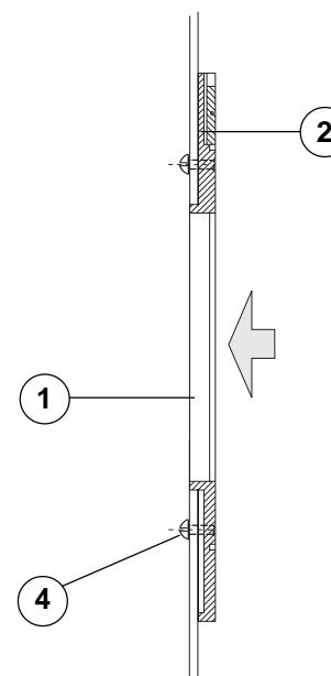
Effectuer le perçage de la porte du compartiment conformément aux cotes indiquées sur le dessin. Fixer la garniture (1) sur la porte du compartiment en introduisant les vis (4) dans les trous correspondants.
