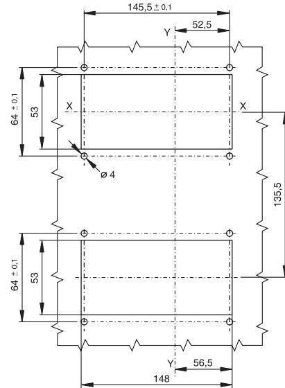
Eseguire la foratura della porta della celda in base alle indicazioni del disegno. Fissare alla porta della cella la mostrina (1) inserendo nei relativi fori le viti (4)
