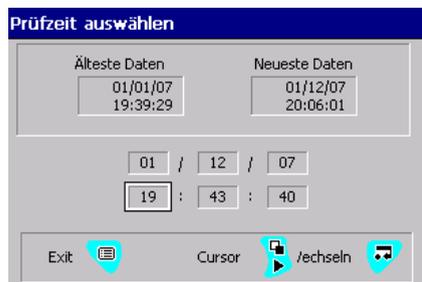
Wählen Sie mit den Tasten ◀ und ▶ das Datum bzw. die Uhrzeit aus. Mit den Tasten ▲ und ▼ können Sie den ausgewählten Wert ändern.
