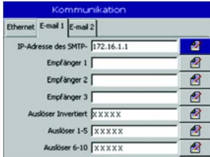
Der Analysator kann so konfiguriert werden, dass er bei bestimmten Ereignissen E-Mails an bis zu sechs Empfänger sendet. Die Empfänger können sich auf demselben SMTP-Server anmelden. Der Analysator kann aber auch so konfiguriert werden, dass er über zwei verschiedene SMTP-Server E-Mails an maximal drei Empfänger pro Server sendet.
