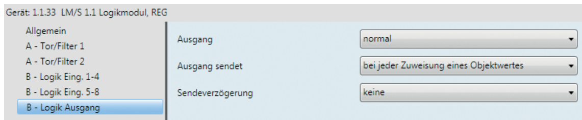
Abb. 93: Logik Ausgang des LM/S 1.1
