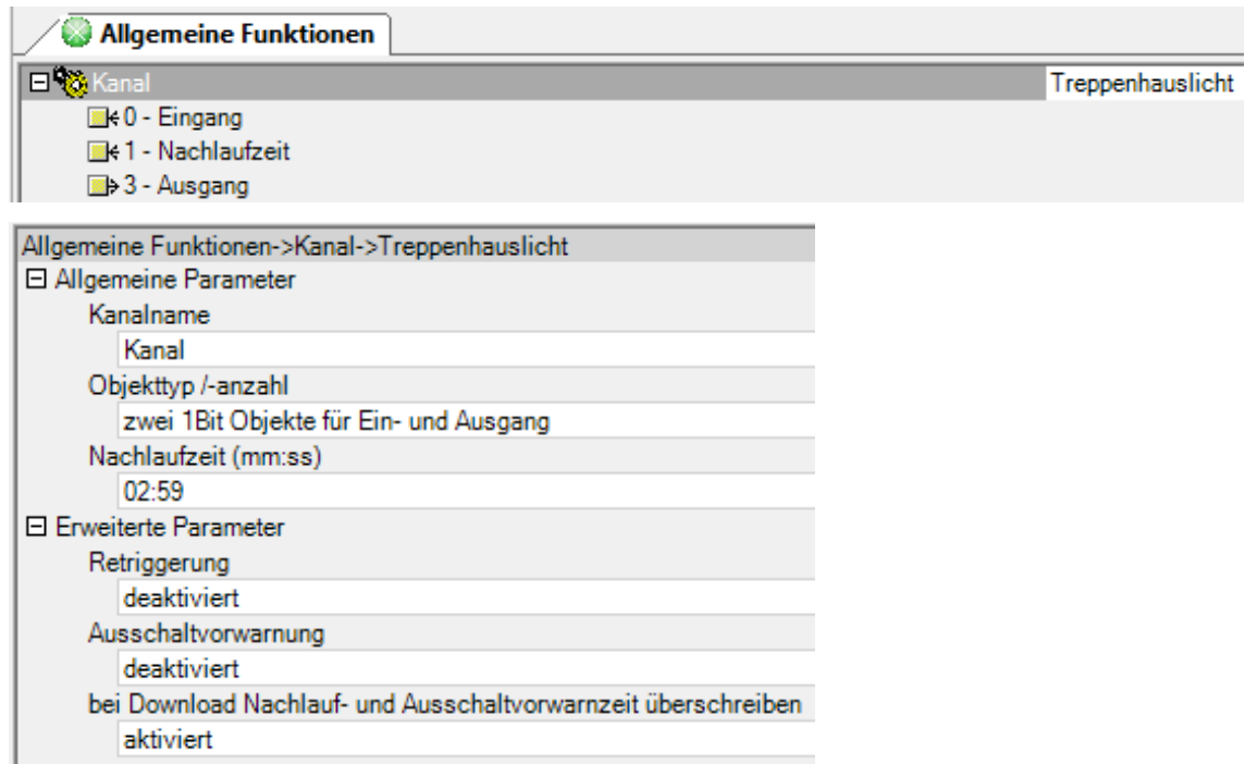
Abb. 34: Kommunikationsobjekte und Parameter Treppenlichtfunktion im Power Tool
