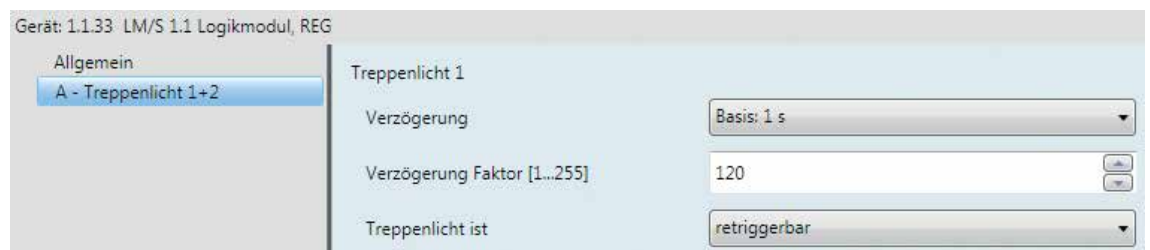
Abb. 30: Parameterfenster Treppenlicht des LM/S 1.1
