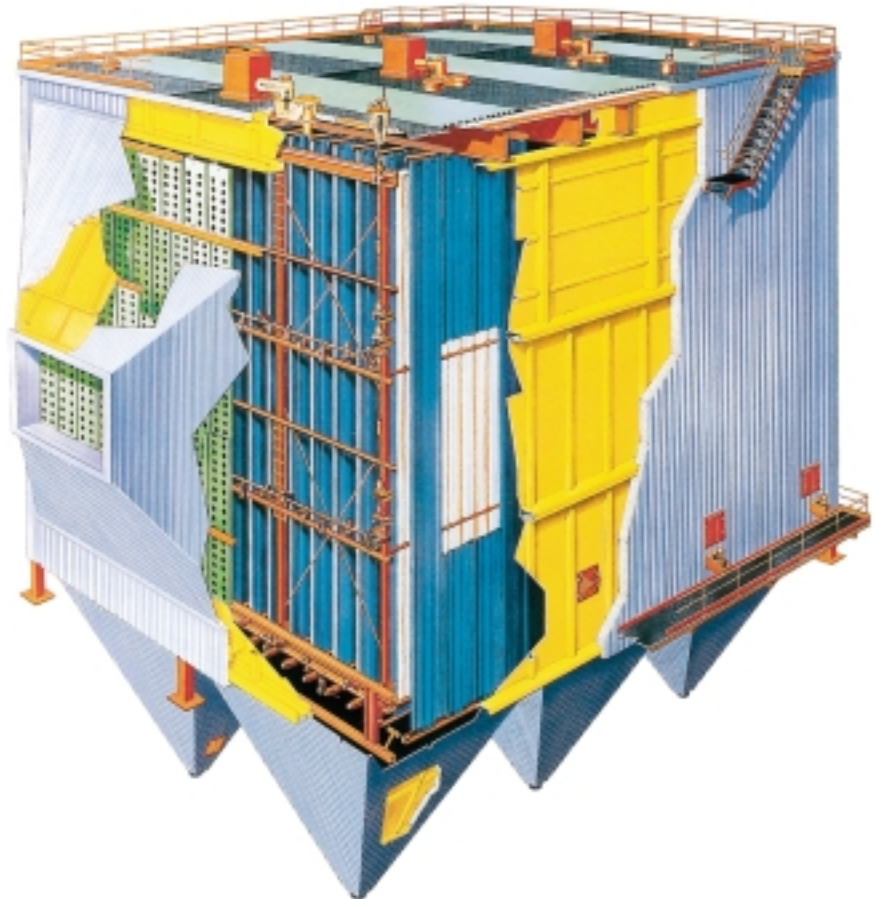
Plan de construction d'un électrofiltre ABB de type FAA. En pénétrant dans l'électrofiltre, le débit des fumées est ralenti et dirigé vers des caissons pouvant atteindre de 15 m de haut.
