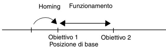
Figura 3 Esempio di funzionamento in modalità Homing
