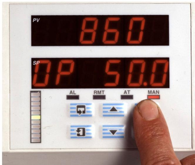
Le clavier tactile et son marquage clair offrent un accès direct aux réglages opérateur et à la programmation de configuration sans avoir à ouvrir la porte de l'enregistreur. Des messages de texte clairs, sur les afficheurs numériques, guident l'opérateur dans les divers menus. Un système de contrôle à mot de passe interdit l'accès non autorisé aux menus de réglage de configuration.
