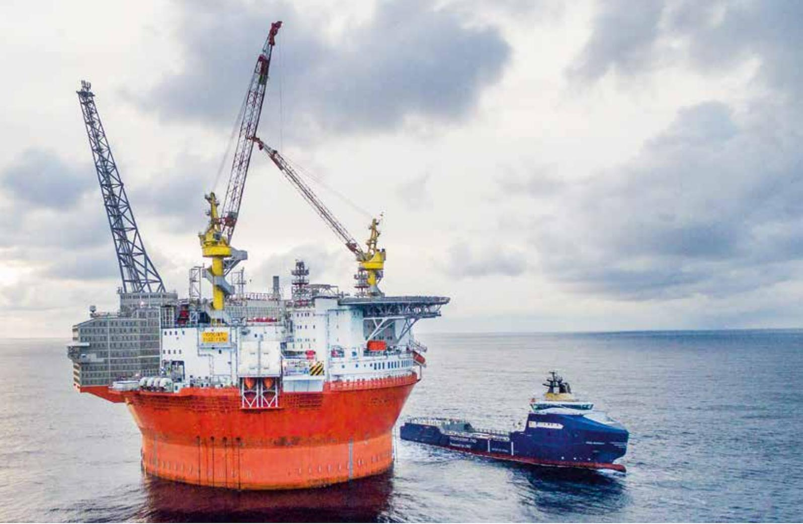
01 Die schwimmende Produktions- und Lagereinheit (FPSO) Goliat, für die ABB einen großen Teil der Elektrifizierung und Automatisierung lieferte.
