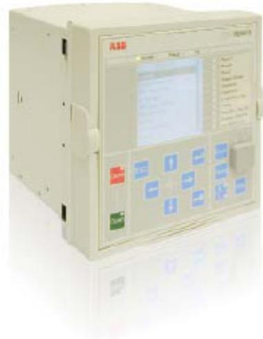
El REM615 también incorpora protección de falla a tierra direccional y no-direccional, protección de sobrecorriente de respaldo, protección de baja tensión trifásica y protección de sobre tensión de secuencia de fase negativa y de baja tensión de secuencia positiva. Mejorado con una tarjeta opcional enchufable, REM615 ofrece un sistema rápido de tres canales de protección de falla de arco para supervisión de flameo de arco en los compartimientos de tableros.
