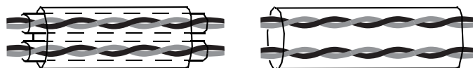
Figura 9 Cable de par trenzado con protección doble, a la izquierda, y cable multipar trenzado con protección única, a la derecha.
