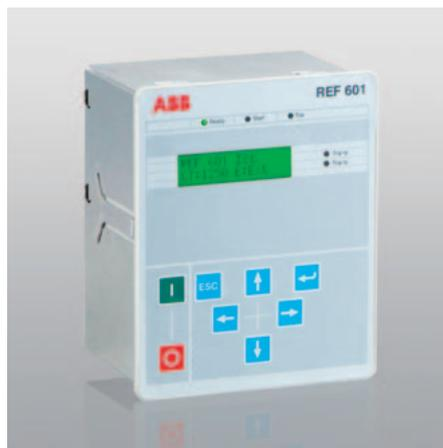
Questo dispositivo di protezione è alternativo all'analogo PR521; a differenza del PR521 che è autoalimentato, il REF 601 necessita della tensione ausiliaria per il suo funzionamento; può equipaggiare, a richiesta, tutte le serie di interruttori HD4 con comando laterale; in particolare è l'unico dispositivo di protezione che può essere installato a bordo della versione HD4/R-SEC.
