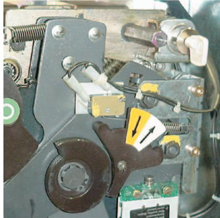
Inserito in un circuito elettrico realizza la segnalazione dello stato delle molle di chiusura del comando.
