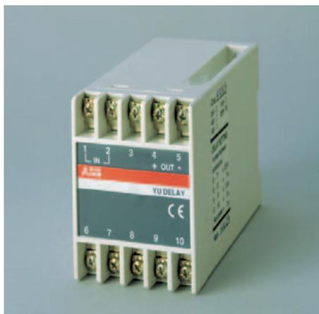
Permette di ritardare l'apertura (da 0,5 s a 3 s) dell'interruttore in caso di abbassamento o mancanza della tensione di alimentazione.
