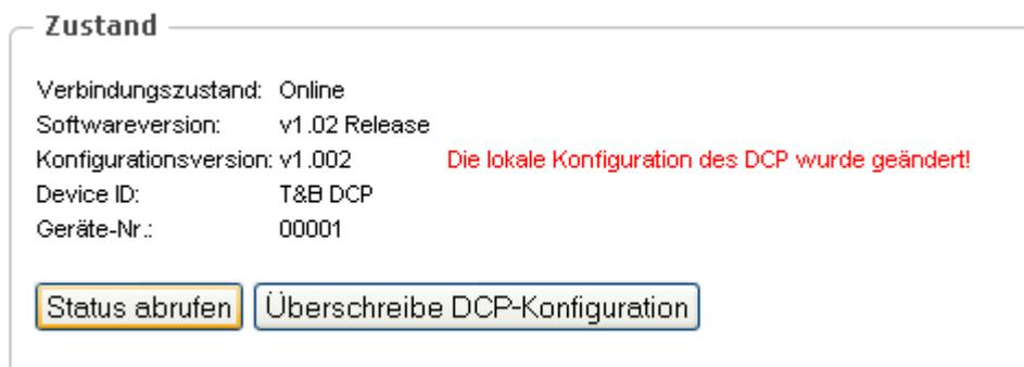
Bild 8.14: Zustandsanzeige vom DCP mit Hinweis auf Unsynchronität
