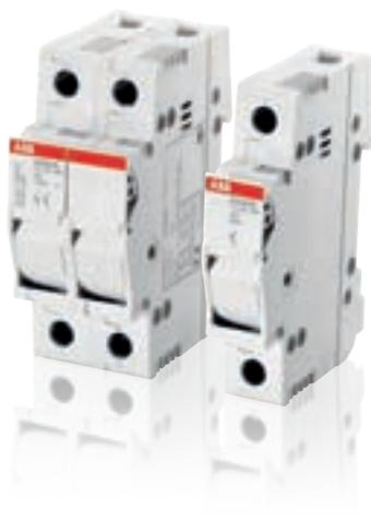
La serie di sezionatori fusibili E 90 PV è progettata per tensioni fino a 1.000 V in corrente continua con categoria di utilizzo DC-20B. La serie E 90 PV trova specifico impiego nella protezione dalle sovracorrenti in impianti fotovoltaici e fornisce una soluzione affidabile, compatta ed economica poiché utilizza fusibili cilindrici 10,3 x 38 mm. Le principali caratteristiche dei sezionatori fusibili E 90 PV sono:
