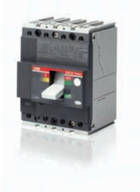
I sezionatori della serie Tmax PV sono disponibili con correnti d'impiego nominale in categoria DC-22B fino a 1600 A, per una tensione nominale d'impiego massima di 1100 Vc.c..
