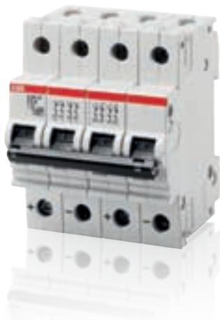
La gamma di interruttori modulari S280 UC è equipaggiata con magneti permanenti sulle camere ad arco interne che permettono di spezzare l'arco elettrico fino a 500 Vc.c. con  $I_{cu}=4,5kA$ . La presenza però di questi elementi stabilisce la polarità dell'interruttore per cui la loro alimentazione va eseguita rispettando un determinato verso. Riportato a fianco lo schema di come devono essere collegati tra la stringa e l'inverter.
