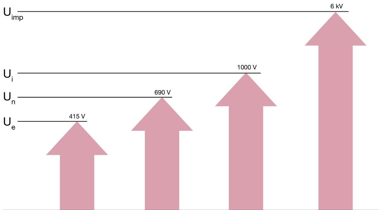
Questa prova in corrente alternata e alla frequenza di 50 Hz, che consente di definire la tensione nominale d'isolamento  $U_i$ , è necessaria ed esclusiva, nel senso che non ammette verifiche alternative di calcolo o attraverso valutazioni; è dunque imperativa per il costruttore originale. Dopo aver sezionato a monte e a valle tutti i circuiti attivi, la prova si effettua in due fasi distinte, sui circuiti principali e su quelli ausiliari.
