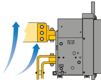
Connessione inferiore con terminali anteriori. La circolazione dell'aria, in prossimità dei terminali superiori (verticali) è solo parzialmente ridotta.
