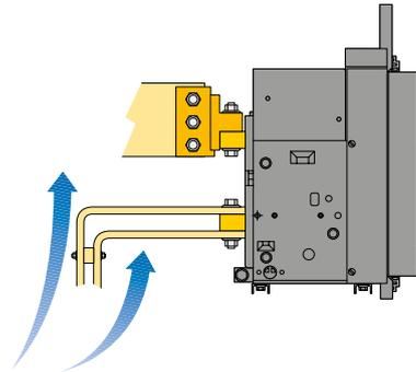
Connessione inferiore con terminali posteriori orizzontali. La circolazione dell'aria, in prossimità dei terminali superiori (verticali) è limitata.
