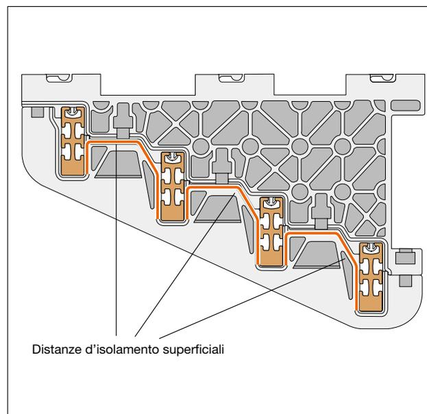
Come di consueto, in questa procedura si deve tener conto anche del tipo di sostanza isolante e del suo coefficiente di Tracking CTI, espresso in volt, che esprime la massima tensione di tenuta supportabile senza formazione di scarica. Più pregiato è il prodotto (vetro, ceramica) più alto è tale coefficiente (600 e oltre) e più basso è il relativo gruppo del materiale.
