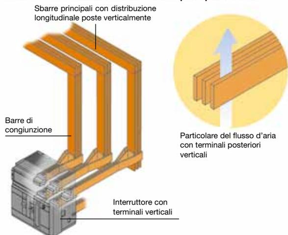
Come evidenziato in Figura 11.9 l'utilizzo dei terminali verticali comporta una laboriosa connessione con il sistema di sbarre principali posizionate verticalmente nella loro distribuzione longitudinale lungo il quadro.
