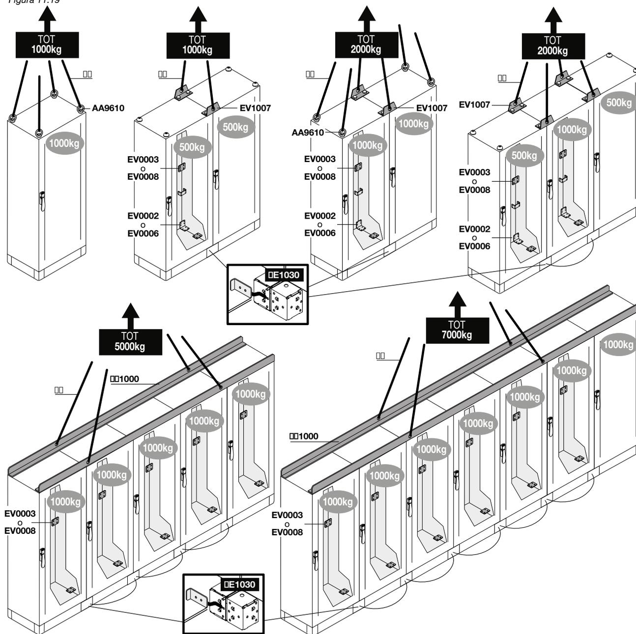
Deve perciò essere montato dopo aver sollevato il quadro (come indicato nella figura 11.20) e averlo posizionato in loco. Nell'accoppiamento di più scomparti emerge la necessità di rispettare le massime portate statiche sia per garantire un'adeguata tenuta alle vibrazioni sia per consentire un corretto sollevamento e trasporto sul luogo finale di destinazione.
