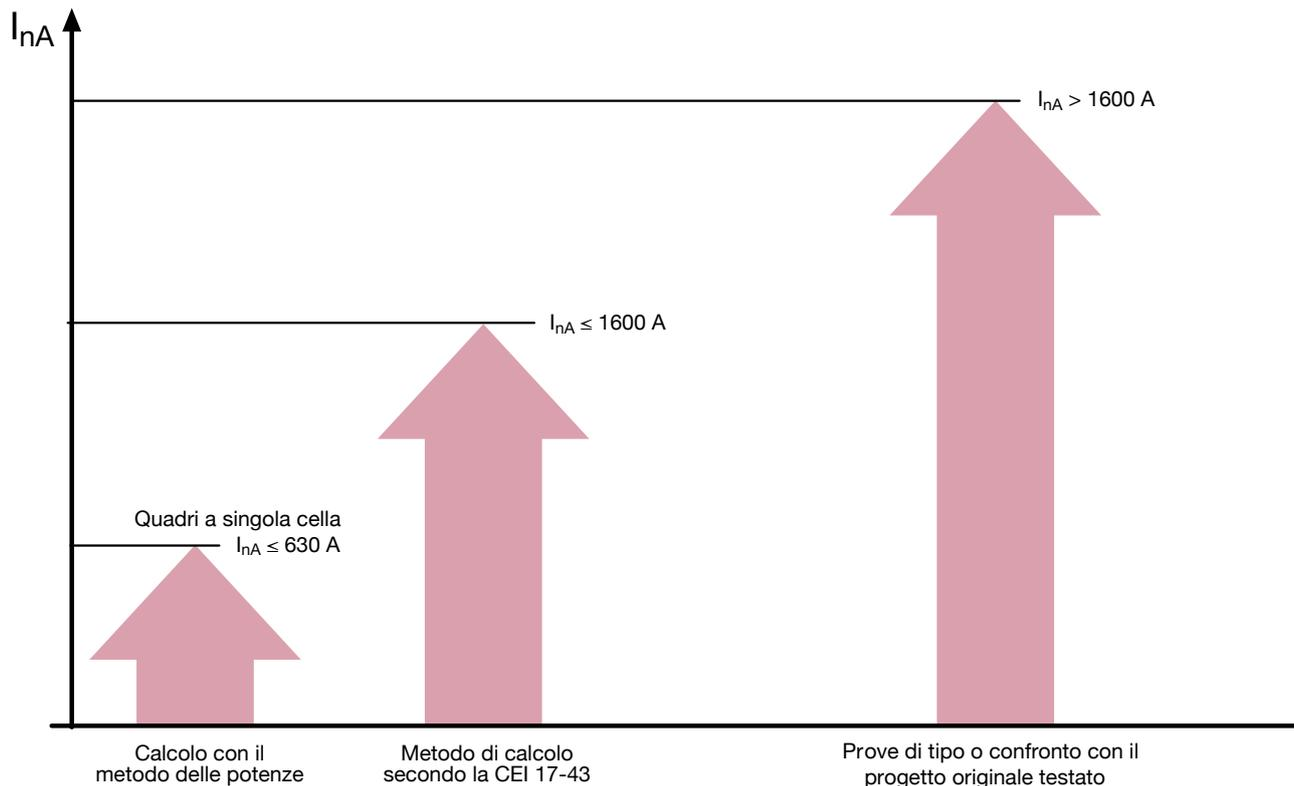
Con i soli metodi di calcolo si può verificare la conformità alle sovratemperature dei quadri:
