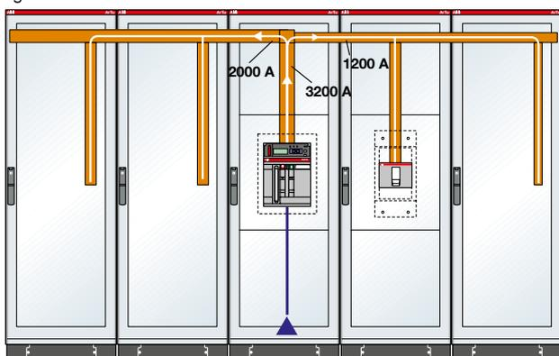
Nell'esempio in figura il sistema di barre principale può essere dimensionato per 2000 A, con un notevole vantaggio economico.
