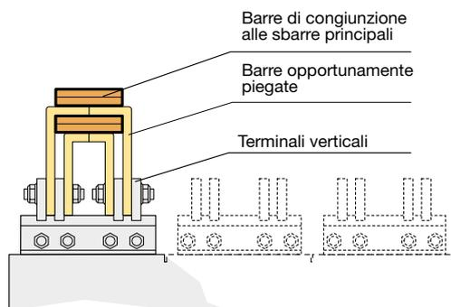
In Figura 11.11 sono riportati, a titolo esemplificativo, altri tre disegni che mostrano una ipotetica soluzione per il collegamento dei terminali verticali alle barre di congiunzione relativamente ad interruttori Emax E3.
