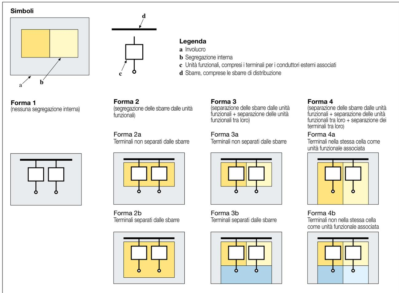
I quadri ABB SACE ArTu K possono, mediante kit, realizzare le seguenti forme di segregazione:
