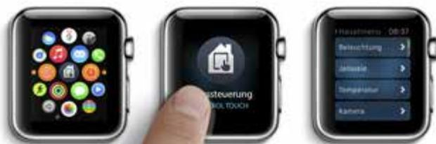
**Smartphones, Tablets und Smartwatches werden zur praktischen Fernbedienung, dank Busch-ControlTouch®. Es verbindet die KNX-Installation mit dem IP-Netzwerk und steuert alle KNX-Funktionen im Gebäude. Die Applikationen für iOS und Android schaffen eine intuitive Bedienung. So können Schalter, Dimmer, Jalousien, Szenen, IP-Kameras, SONOS Wireless-Boxen und Philips-Hue-Leuchten in das System eingebunden werden.**
