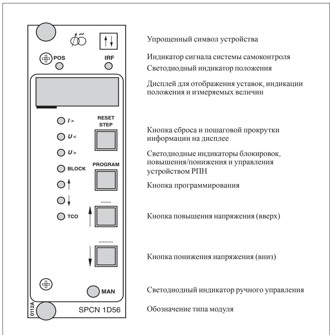
Рис. 1. Передняя панель модуля ручного регулирования напряжения SPCN 1D56.
