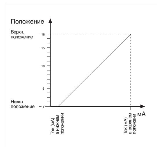
Пример 2. Калибровка токового входа при неработающем трансформаторе. Для калибровки устройство РПН поднимается и опускается в высшее и низшее положения.
