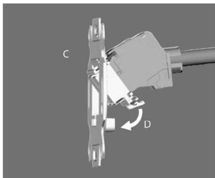
2 Positionnez le logement pour module avec la gorge moulée dans la plaque de support (C), pivotez-le ensuite vers le bas (D) jusqu'à ce qu'il s'enclenche dans la plaque de support de manière audible
