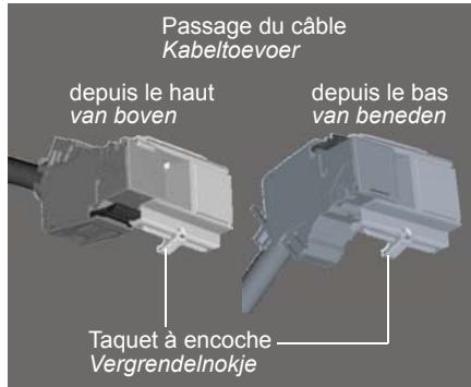
1 Faites glisser le module prémonté en fonction du passage du câble depuis la gauche ou la droite dans le logement pour module (le taquet à encoche est toujours dirigé vers le bas)
