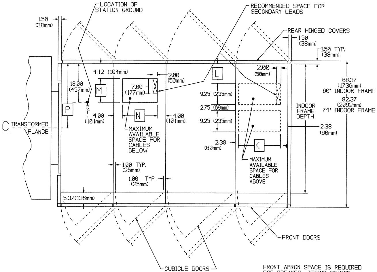
FRONT APRON SPACE IS REQUIRED FOR BREAKER LIFTING DEVICE. (SEPARATE FROM SWITCHGEAR)
