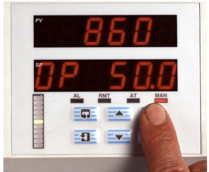
El teclado táctil está claramente marcado y permite que el operador tenga acceso directo para programar los ajustes y la configuración sin necesidad de abrir la puerta del registrador. Los mensajes-guía en los visualizadores digitales dirigen al usuario por los varios menús. Un sistema de seguridad protegido por contraseña evita el acceso no autorizado a los menús de ajuste de configuración.
