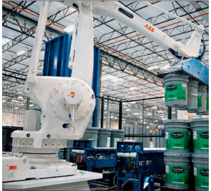
El nuevo Lean ID de ABB equilibra coste y durabilidad integrando las partes más expuestas del equipamiento en el interior del robot.
