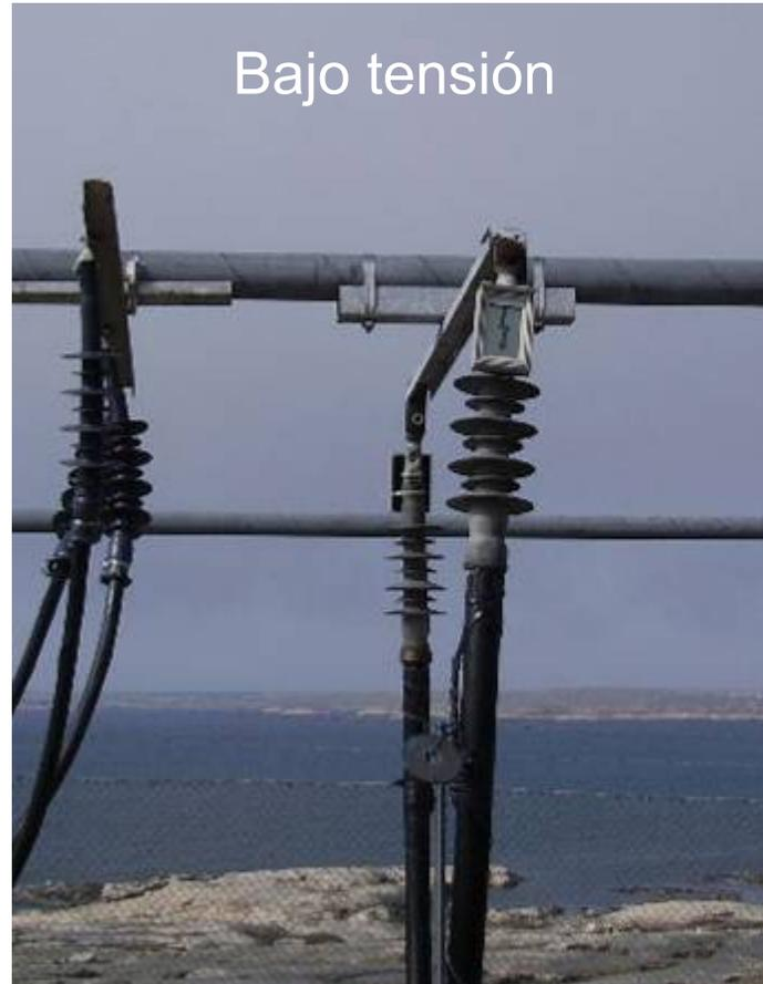
Estación de prueba usada por ABB Kabeldon
