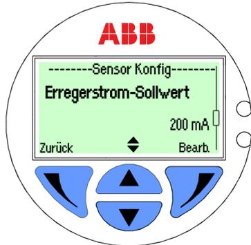
10. Auswählen, ob der Sensor mit einem Vorverstärker ausgerüstet ist. „Ohne Vorverstärker“ auswählen. Die Version mit Vorverstärker ist nicht umbaufähig.
