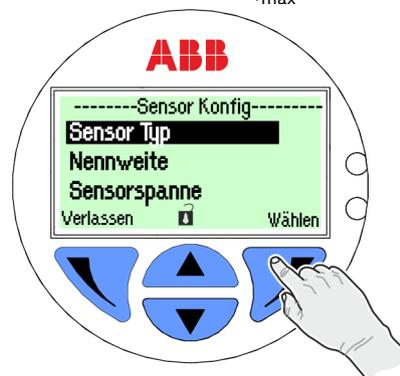
4. Nennweite auswählen und gemäß Typenschild des Sensors eingeben.
