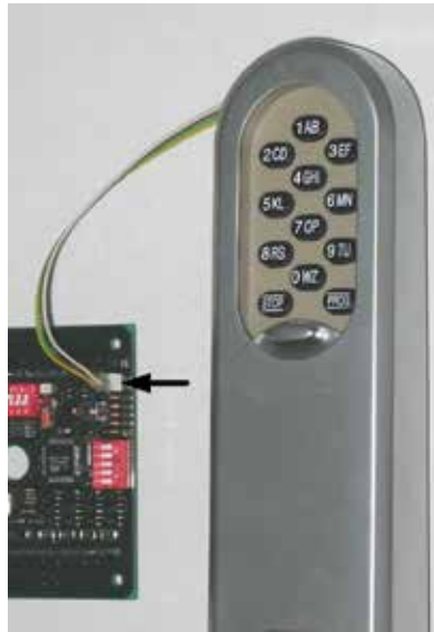
Bild 8-3: Direkter Anschluss Türbeschlag
