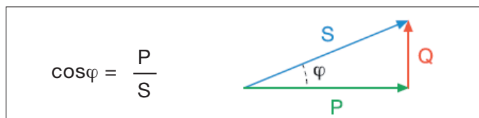
Figura 1.1 – Definição do fator de potência e triângulo das potências
