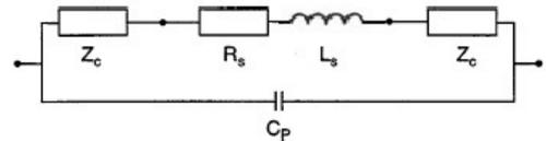
Figure 72: simplified equipotential bonding circuit
