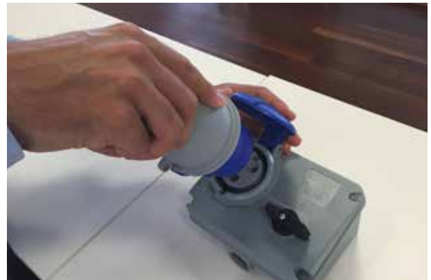
0/OFF konumunda kutuya fiş takılabilir ve çıkarılabilir. Ancak fiş takılmadan I/ON konumuna geçilemez.
