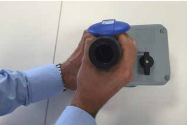
Fiş takılmadan kutu I/ON konumuna geçilemez ve fiş takıldıktan sonra bu konumdayken çıkarılmasına izin vermez.
