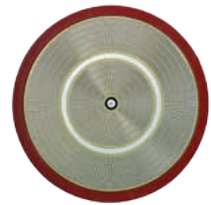
1b Vue de dessus d'une pastille IGCT de 91 mm
