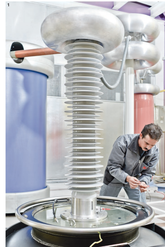
1 Preparación para ensayos de tipo | 2 Sección del bushing EasyDry
