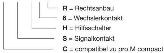
Der S2C-S/H6R ist eine universale Zusatzeinrichtung für das Programm pro Mcompact, die als Signalkontakt ausgeliefert wird, aber auch auf die Hilfsschalterfunktion mittels eines Schraubendrehers umgestellt werden kann. Dieser universale Schalter ist an Leitungsschutzschalter und Fehlerstromschutzschalter anbaubar.
