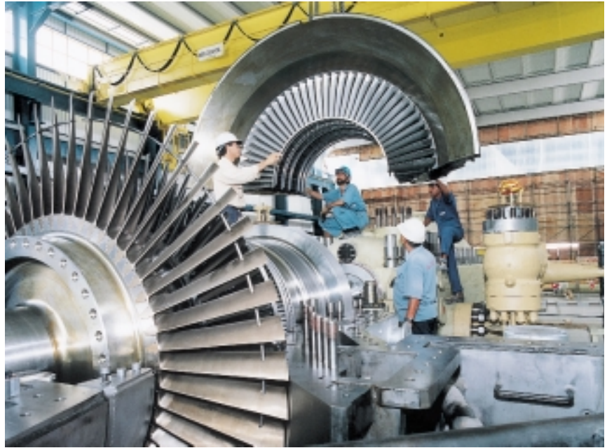
Travaux d'assemblage de l'une des 6 turbines à vapeur. Le cylindre extérieur supérieur de la turbine basse pression est suspendu à la grue. Le dernier étage de l'aubage de cette turbine est visible au premier plan. 4
