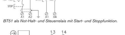
BT51 als Not-Halt- und Steuerrelais mit Start- und Stoppfunktion.
