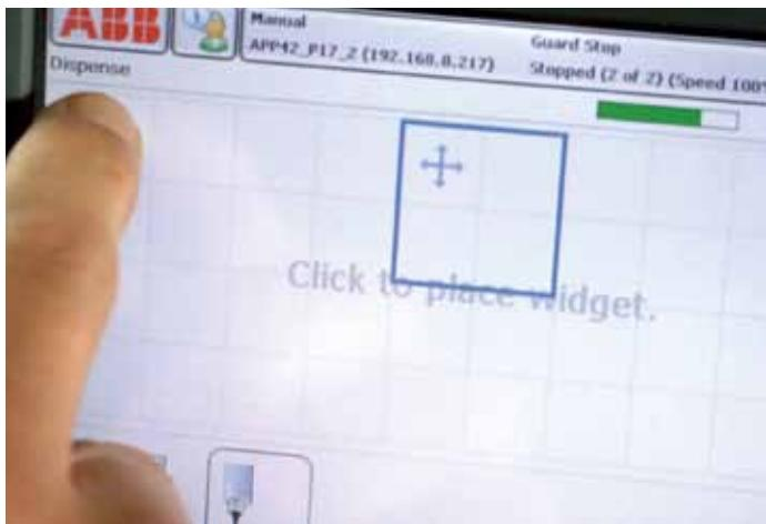
生产屏幕中的图形部件区域是由  $60 \times 60$  像素组成的  $10 \times 4$  网格。可使用 ScreenMaker 创建  $60 \times 60$  像素成倍的图形部件，最大可达  $600 \times 240$  像素。
