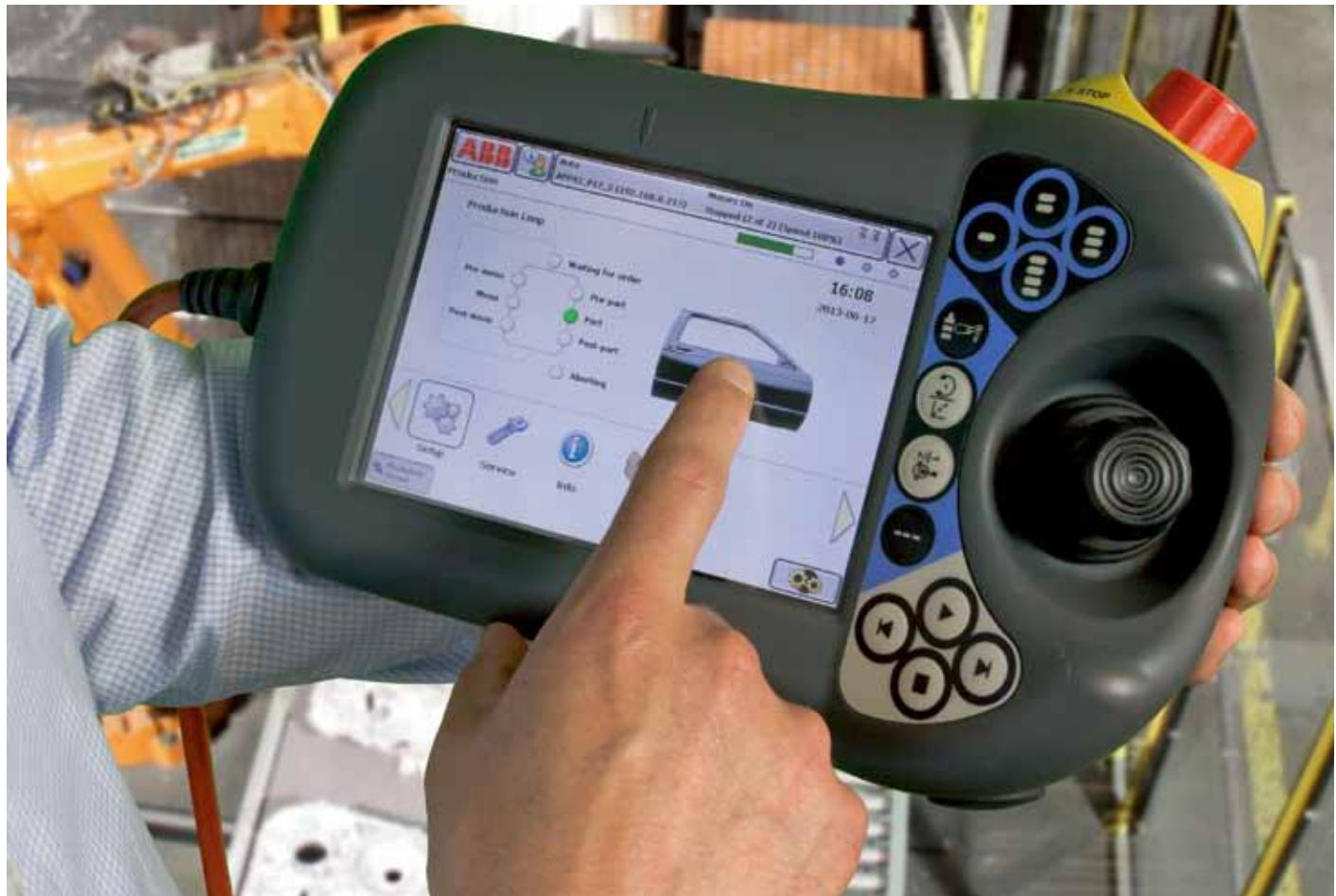
随着智能手机的广泛使用，我们已经习惯于直观的图形操作。我们期待功能直观简单。生产屏幕将智能手机的操作逻辑引入机器人操控终端 FlexPendant，创建出一个便于控制、生产率更高的生产环境。
