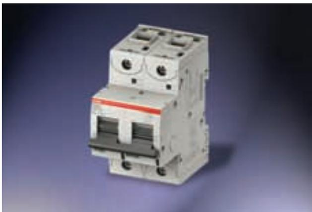
Per la serie di interruttori S800S UC le curve caratteristiche disponibili sono B e K ed entrambe le tipologie hanno correnti nominali fino a 125A e potere d'interruzione di 50kA.
