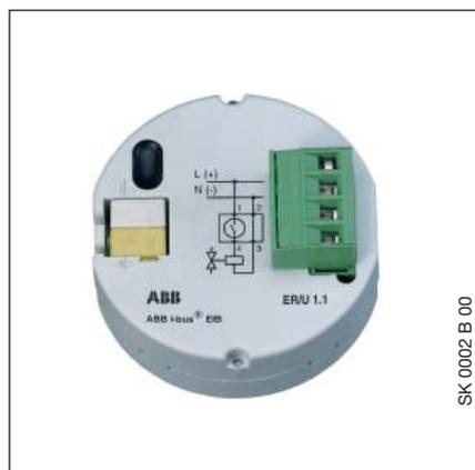
Das elektronische Relais dient der Ansteuerung von elektrothermischen Stellantrieben. In Verbindung mit der Universal-Schnittstelle ist es möglich eine Einzelraumregelung zu realisieren. Das Gerät ist für den Einbau in eine Geräte-Verbindungsdose 60 mm UP vorgesehen.
