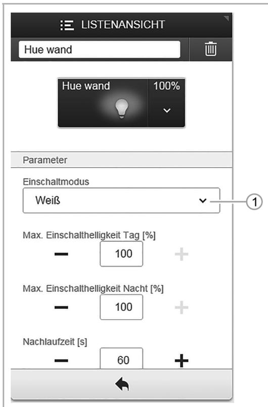
Abb. 90: Aktoreinstellungen Philips Hue Lampe
