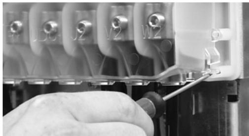
2. Conecte los apantallamientos trenzados de los cables de alimentación a los bornes de conexión a tierra del módulo de convertidor.
