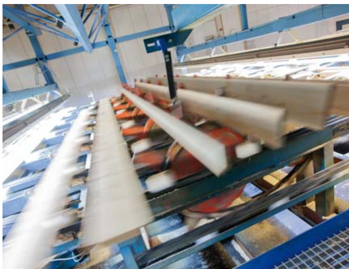
Varvtalsreglering av transportörer är kritiskt del vid sågverk, som till större delen är uppbyggda kring materialhantering.
