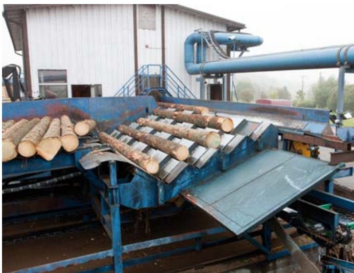
Stockmatning var en del av uppgraderingsinvesteringen som förbättrade produktionseffektiviteten med runt 5 procent.
