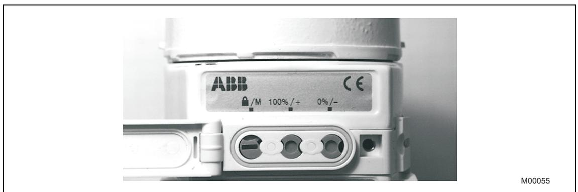
Abb. 18: Schild mit der Tastenbeschriftung
