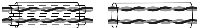
Figura 9 Cavo intrecciato con schermatura doppia (a sinistra) e con schermatura singola (a destra).
