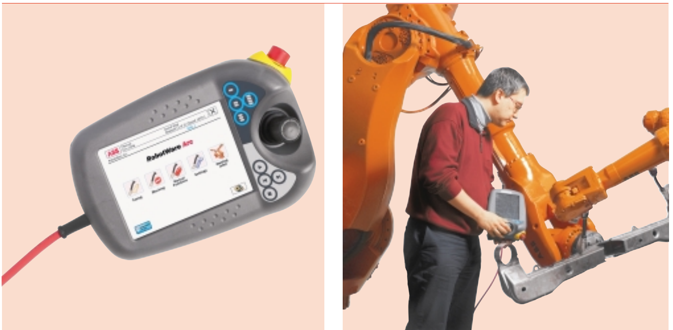
2 ABB 的 Flexpendant (a) 是 IRC5 标准部件的一部分，它通过人机工程学的设计、客户定制的菜单和触摸屏而支持机器人编程人员 (b)。
