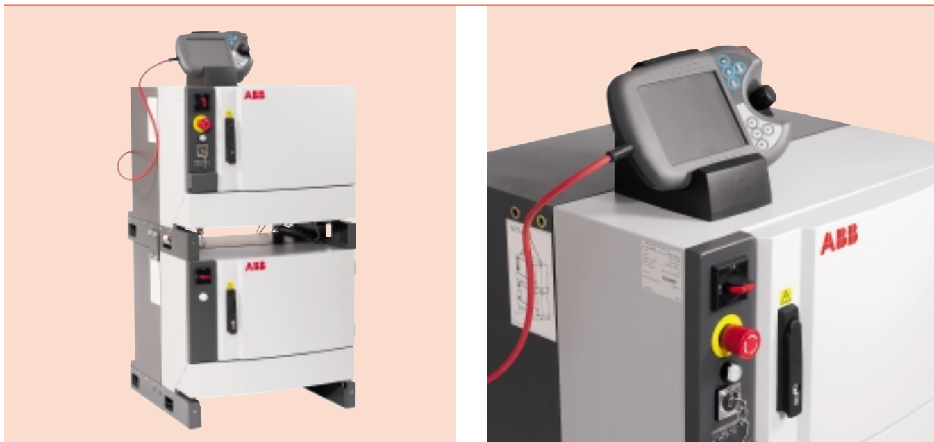
3 同步机器人制造单元的“头脑”是 IRC5 控制器。
