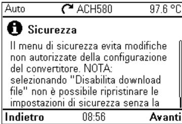
Il sottomenu **Sicurezza** è un menu protetto che può essere aperto con una password. Il menu consente di bloccare azioni e funzionalità con il blocco utente. È anche possibile impostare la password di blocco utente.
