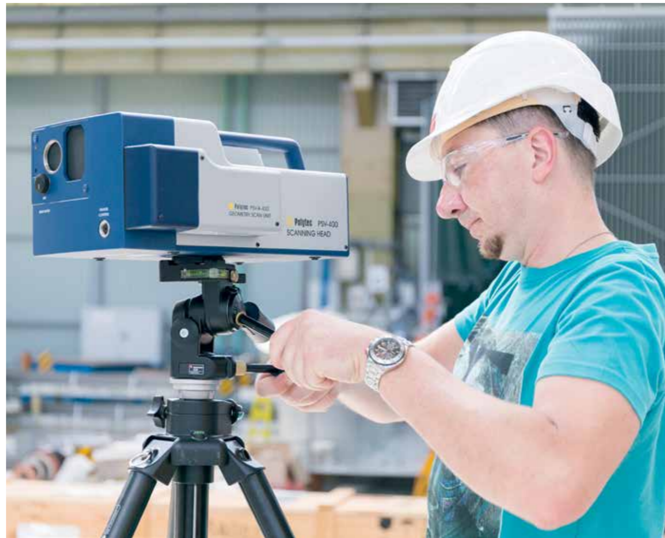
Prowadzone w Łodzi badania mają praktycznie zweryfikować opracowane teoretycznie założenia. Analiza przeprowadzana jest za pomocą nowoczesnego wibrometru laserowego, który dokonuje pomiarów wiązką laserową bezdotykowo i w trzech wymiarach. Efektem analizy są precyzyjne animacje i zdjęcia pokazujące poziom i miejsca vibracji ścian kadzi.
