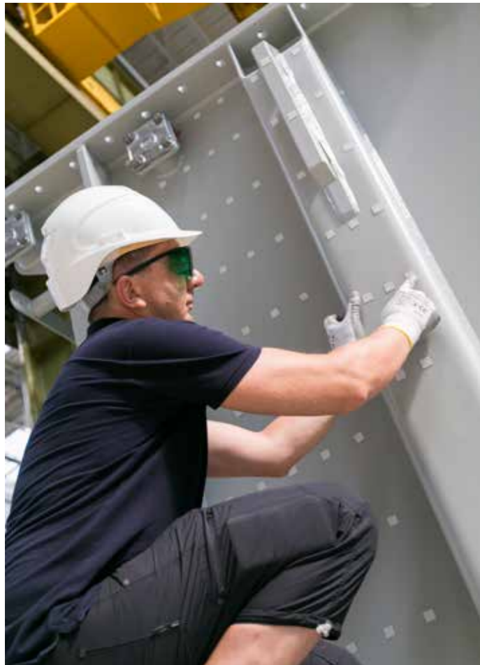
Prowadzone w Łodzi badania mają praktycznie zweryfikować opracowane teoretycznie założenia. Analiza przeprowadzana jest za pomocą nowoczesnego wibrometru laserowego, który dokonuje pomiarów wiązką laserową bezdotykowo i w trzech wymiarach. Efektem analizy są precyzyjne animacje i zdjęcia pokazujące poziom i miejsca vibracji ścian kadzi.
