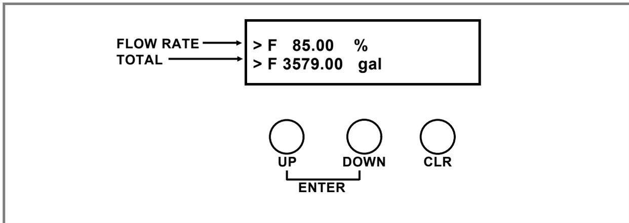
**FIGURE 3-4. 50XM1000 DISPLAY AND PUSHBUTTONS**
