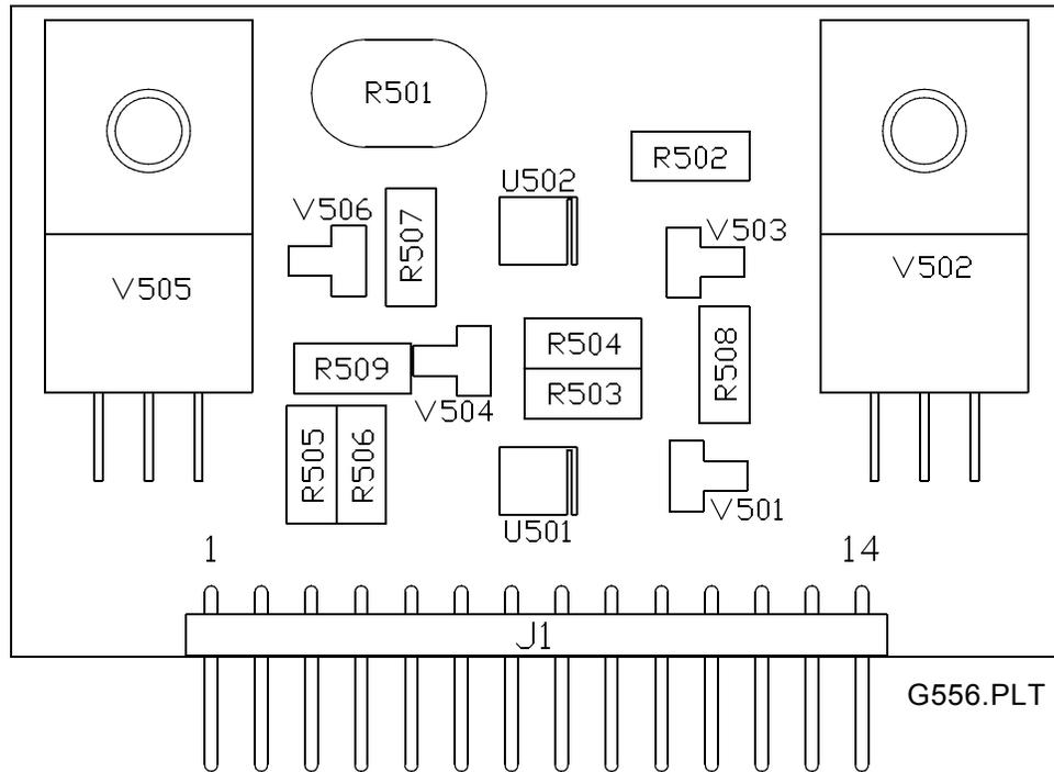
**FIGURE 6-2. ACTIVE PULSE OUTPUT MODULE**
