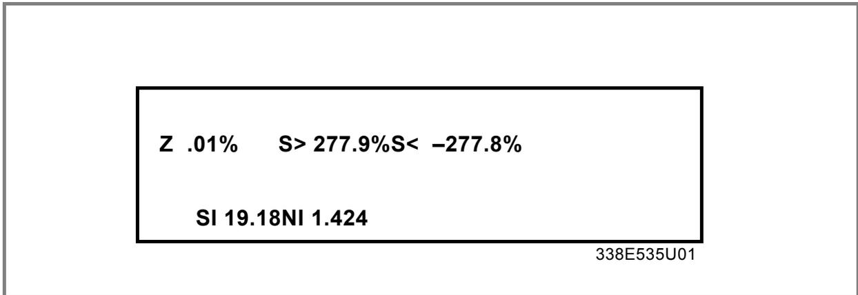
FIGURE 3-2. TYPICAL 50XM1000 CALIBRATION TAG
