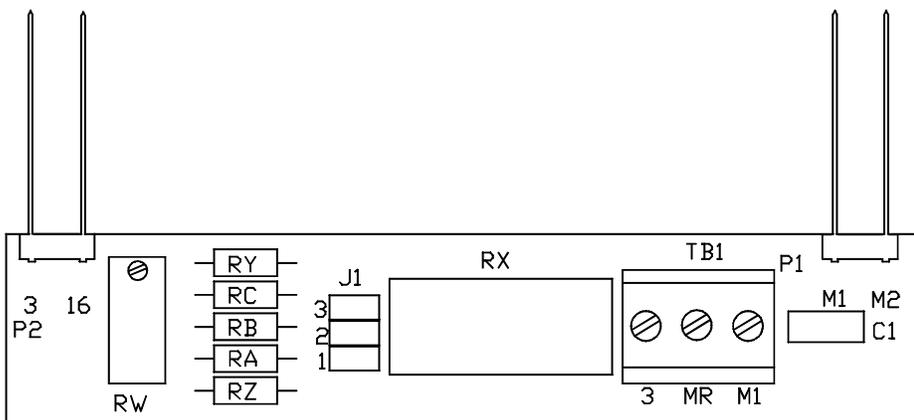
**FIGURE 6-4. 686B735U07 CURRENT-SENSE MODULE**
