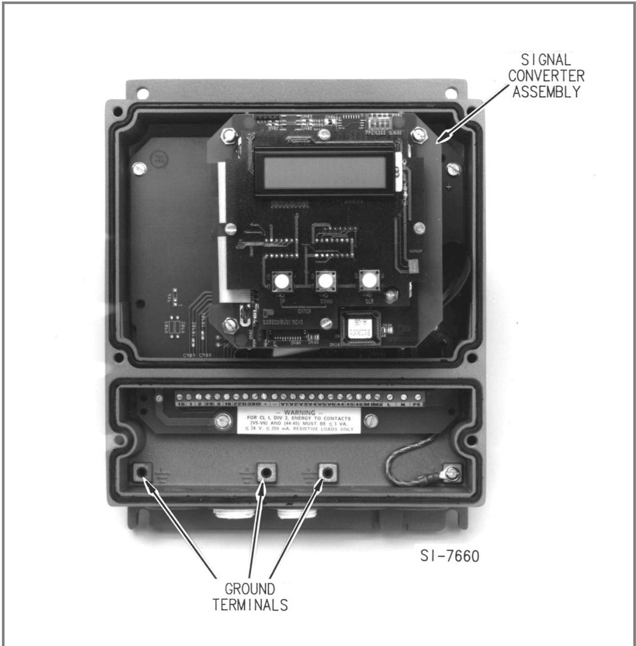
**FIGURE 1-3. ENCLOSURE MOUNTED SIGNAL CONVERTER SHOWING SIGNAL CONVERTER AND GROUND TERMINALS**
