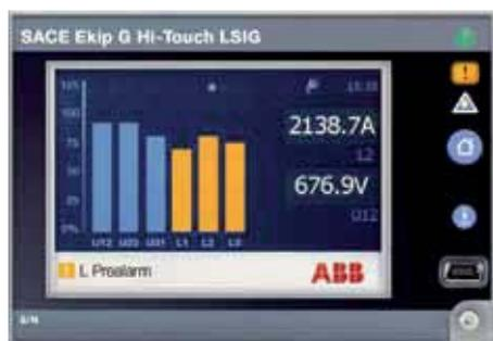
Auf der Frontseite des Auslösers gibt es auch zwei Leuchtdioden: eine LED für Voralarm (viereckige gelbe LED) und eine LED für Alarm (dreieckige rote LED). Eine Meldung auf dem Display begleitet immer die Blinkanzeigen der Leuchtdioden, um Ereignisse jeder Art eindeutig identifizieren zu können. Die Liste der augenblicklich aktiven Alarime kann durch einfaches Berühren des Displays auf dem weißen Streifen unten links im Alarimbereich angezeigt werden.
