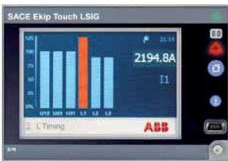
Andernfalls ist es möglich, auf der Default-Seite Histogramme zu wählen, um die Ströme der drei Phasen und des Neutralleiters auf einer Skala von 0-125% zusätzlich zum numerischen Wert der an stärksten belasteten Phase anzuzeigen. Die Histogramme nehmen bei Überlast im Fall eines Voralarms eine gelbe und bei einem Alarm eine rote Farbe an, damit die anomale Bedingung sofort erkannt werden kann.
