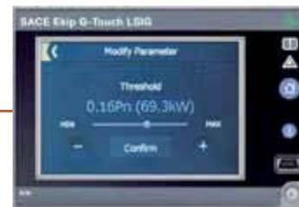
Ekip G dient für den Generatorschutz ohne die Benutzung externer Einrichtungen, die besondere Relais und Verdrahtungen verlangen.
