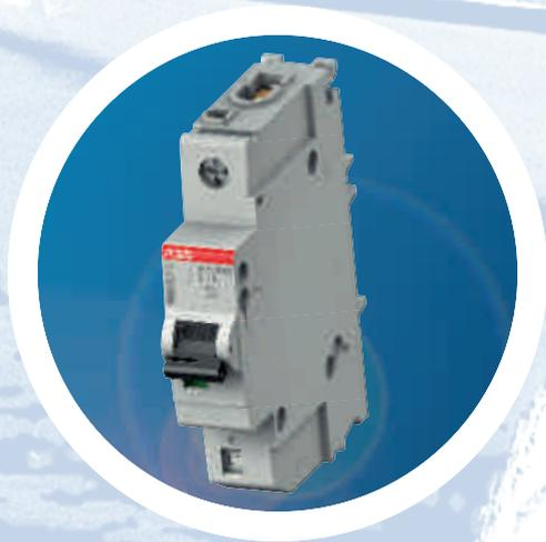
Ein Leitungsschutzschalter S400 UC bzw. S450 UC mit der Charakteristik C und Z. Er ist speziell für den Einsatz mit Gleichstrom gebaut, kann aber auch für Wechselstrom verwendet werden.
