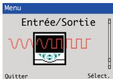
Permet de configurer les entrées / sorties analogiques et numériques et les relais.
