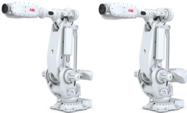
Bei den Modellen IRB 7710 und IRB 7720 lag der Entwicklungsschwerpunkt auf einem effizienten modularen Design. Die Modellreihe bietet Energieeinsparungen von bis zu 30%\* und liefert gleichzeitig Leistung und Qualität auf Weltklasseniveau. Sie umfasst 16 Varianten mit Traglasten von 280 kg bis 620 kg.
