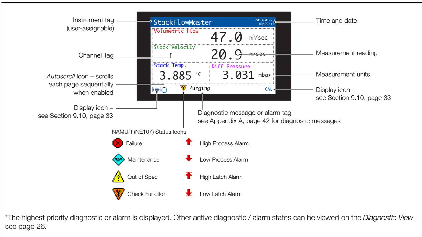
Fig. 9.4 Operator Page 1 – default template Qv, V, T, DP
