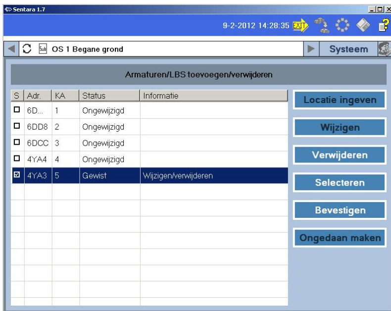
Figuur 4.27: Armatuur/LBS geselecteerd voor verwijderen
