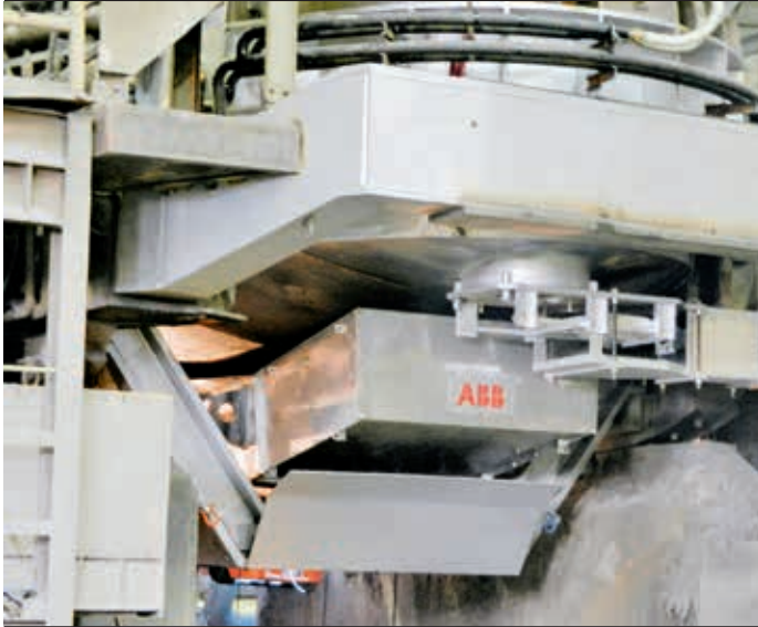
1a Der unter dem Ofen angeordnete Rührer von ABB
